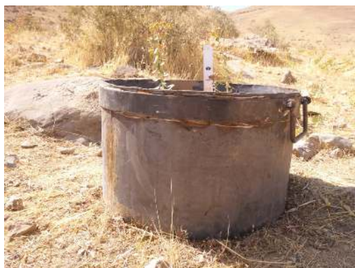
شکل ۲: اندازه‌گیری میزان نفوذپذیری با استفاده از استفوانه - های مضاعف
