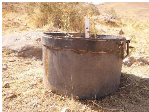
شکل ۲: اندازه‌گیری میزان نفوذپذیری با استفاده از استوانه‌های مضاعف
