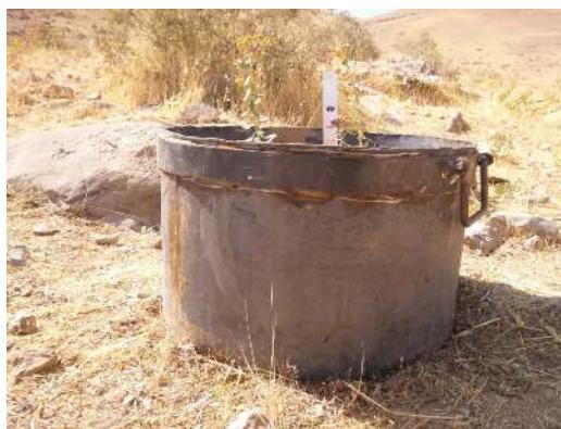
شکل ۲: اندازه‌گیری میزان نفوذپذیری با استفاده از استفوانه‌های مضاعف
