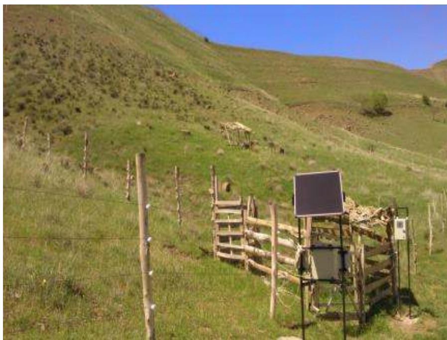
شکل ۱- پنل خورشیدی، انرژی‌ز و سیم‌های حصار الکتریکی
