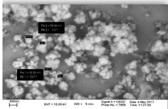
شکل ۱- تصویر میکروسکوپ الکترونی عبوری از نانوسیلیکات پتانسیم
