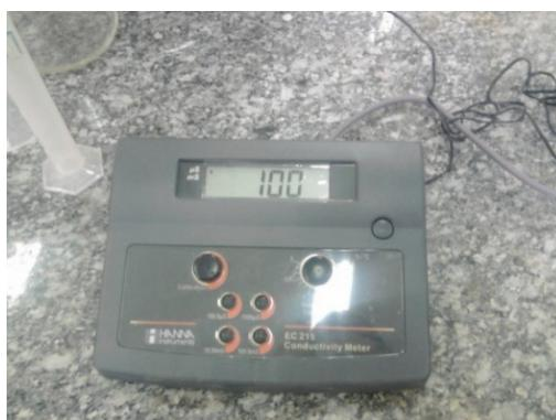
شکل ۳: دستگاه EC متر برای اندازه‌گیری هدایت الکتریکی
