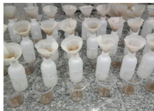
شکل ۲: نمونه‌ای از مراحل اندازه‌گیری فسفر در آزمایشگاه
