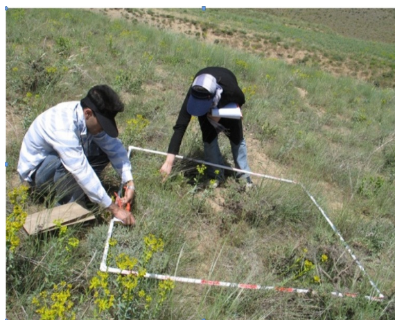
شکل ۲- پلات مورد استفاده در اندازه گیری پوشش گیاهی در حوزه زوجی گنبد
